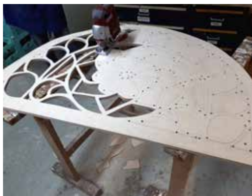
Abb. 2: Herstellung der „Fensterrahmen“ bei ZAB.
