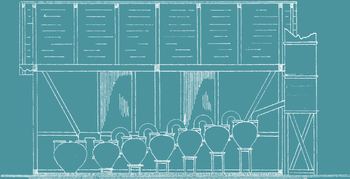
Anlage zur Reinigung der Abluft durch Kondensationsgefäße; rechts der „Röhrenturm“ (Bauamt Fürth)
